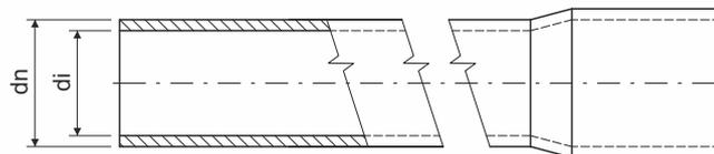
Produktbeschreibung: Kunststoffstangenrohr, flammwidrig, mit angeformter Muffe
