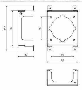
Produktbeschreibung: Geräteträger zur Montage einer 400 V Einbausteckdose (16 A)
