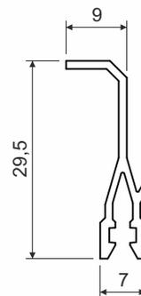
**Produktbeschreibung:** wird verwendet, um das Innere der Kanäle zu unterteilen und so eine bessere Handhabung der eingeführten Kabel und Übersicht zu ermöglichen
