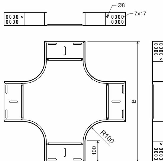
**Produktbeschreibung:** Die Kreuzung dient der Verbindung von Kabelrinnen oder Kabelleitern gleicher Breite auf einer Ebene.
