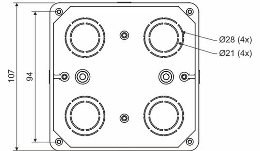
Produktbeschreibung: geeignet für Leitungen mit einer Spannung bis 400 V und einer Stromstärke bis max. 16 A
