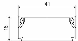
Produktbeschreibung: geeignet zur Verlegung von Niederspannungsleitungen
