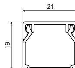
Produktbeschreibung: geeignet zur Verlegung von Niederspannungsleitungen
