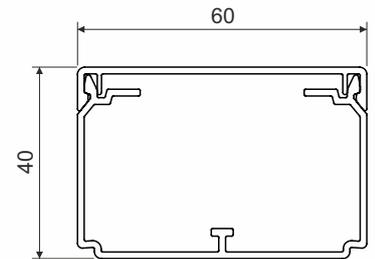
Produktbeschreibung:: bestimmt zur Installation von Niederspannungsleitungen
