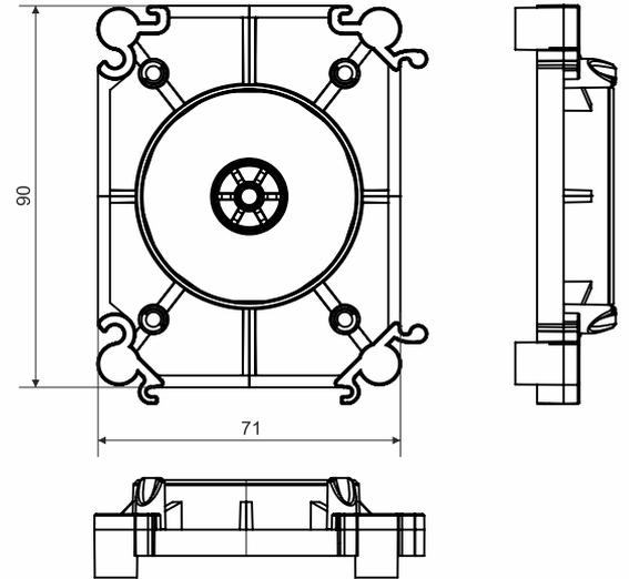
Produktbeschreibung: Stützplatte zur Abstützung der Betondosen an der gegenüberliegenden Schalung
