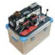
Mittels einer laminaren Luftströmung und zusätzlichem mechanischem Kabelvorschub schwebt der Lichtwellenleiter ins Leerrohr und wird nach vorne verschoben.
