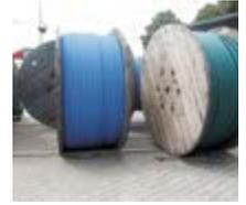
Nach Abnahme einer Trommelseite wird der Ring auf die Trommel aufgesetzt, die Seite wird eingeklappt und die Trommel ist zur Abwicklung bereit. Ein Vorteil dabei ist die Einsparung von Frachtkosten beim Transport größerer Mengen Holztrommeln.
